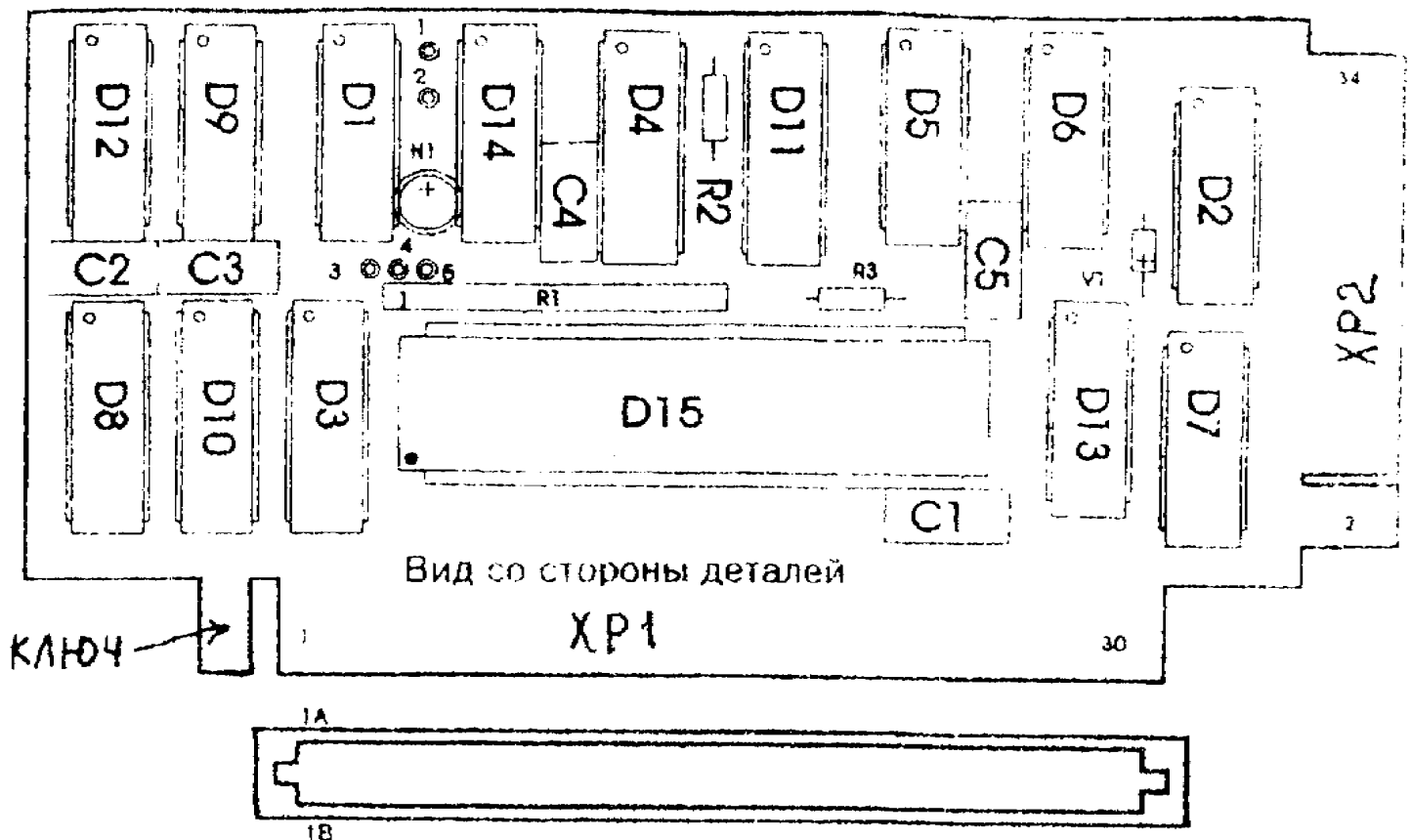
Рис. 6.2. Монтажная схема контроллера дисководов "Beta-Turbo"
